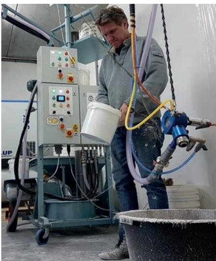
Sprühen mit zerkleinerten Fasern
