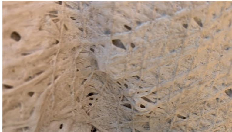
Wir empfehlen außerdem, die einzelnen Glasfasergewebeschichten (abwechselnd mit A1 Schichten) direkt nacheinander anzubringen. Dieses nass-in-nass arbeiten sorgt für einen optimalen Verbund der einzelnen Schichten.
