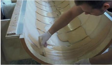
Bei der Laminierung wird zunächst eine 1. Schicht A1 aufgetragen, die mit Thix A angegedickt werden kann und meist um Pigmente, Sand, Metallpulver und/
